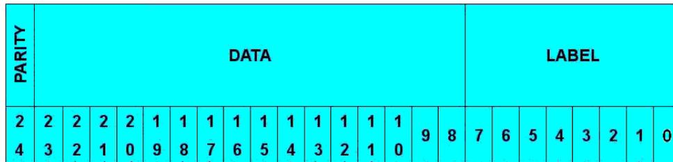
图 26-2 处理器中 ARINC429 总线控制器字长为 25 位的数据字格式
